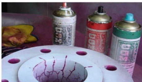
شکل ۱-۶۲: عیب‌یابی به روش تست مایع نافذ
