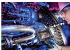
شکل ۱-۵۸: بوریسکوپ در بازرسی چشمی
