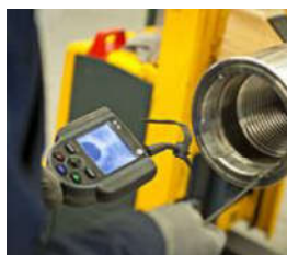
شکل ۱-۵۹: اندوسکوپ در بازرسی چشمی
