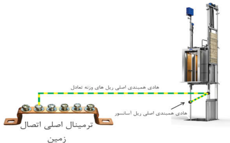
شکل ۳-۸۹ اتصال ریل و وزنه تعادل آسانسور به شینه اصلی اتصال زمین (همبندی اصلی)
