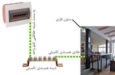
شکل ۳-۷۶) همبندی ستون فلزی موجود در آشپزخانه
