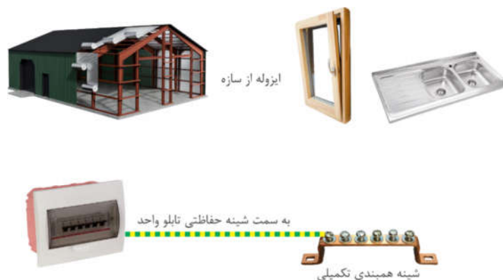
شکل ۳-۷۵) عدم اتصال قاب فلزی پنجره و سینک ظرفشویی به شینه همبندی اضافی به علت آنکه با سازه در ارتباط نمی‌باشند.
