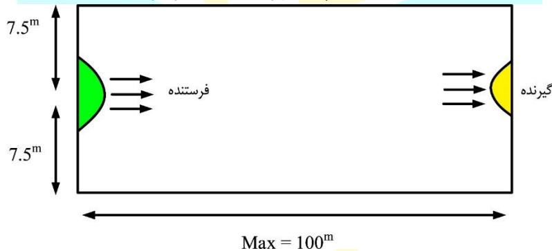
شکل ۴۴-۱) شکل پیوست ۴-۹- فواصل طولی و عرضی دتکتور دودی شعاعی
