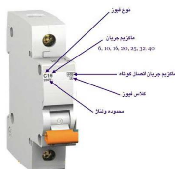
شکل ۴۱-۱) ساختمان کلید مینیاتوری
