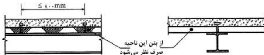
شکل (۳-۵): عرشه فولادی که کنگره‌های آن عمود بر محور طولی تیر است. (۱۰-۲-۸-۸)
